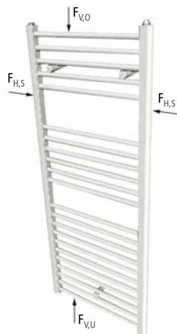
Bild 1: Typische Krafteinwirkung am Beispiel eines Badheizkörpers
