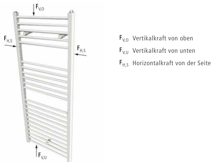
Bild 1: Typische Krafteinwirkung am Beispiel eines Badheizkörpers
