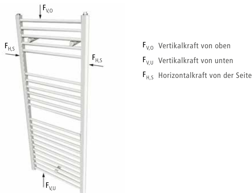
Bild 1: Typische Krafteinwirkung am Beispiel eines Badheizkörpers
