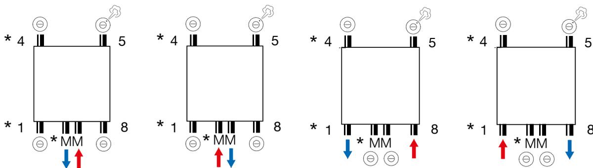
\*Raccordement MM, 1 et 4 déjà scellé en usine
