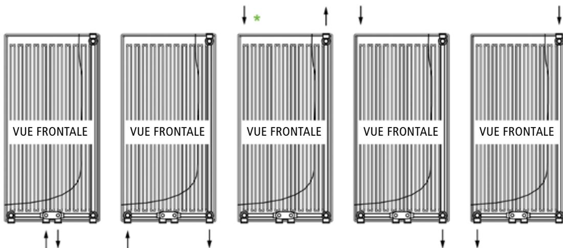
Type 20-22 : raccordement par le haut avec bouchon 13911990010 possible
