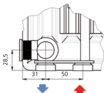
Raccordement de la vanne à gauche :
