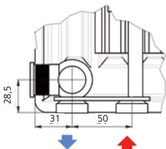
Raccordement de la vanne à gauche :
